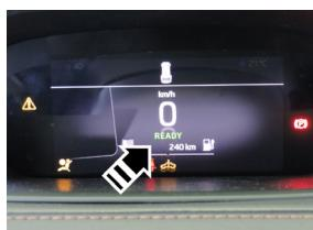
Le moteur électrique est silencieux. Le tableau de bord indique si la traction électrique est désactivée "OFF" ou en état de marche "READY".
